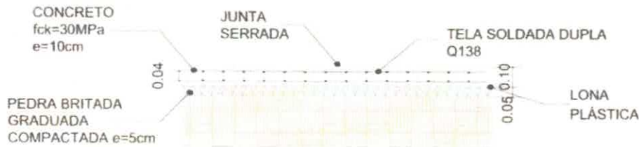
DETALHAMENTO DE PISO DE CONCRETO ARMADO EM TELA COM JUNTA SERRADA ESC 1:25
