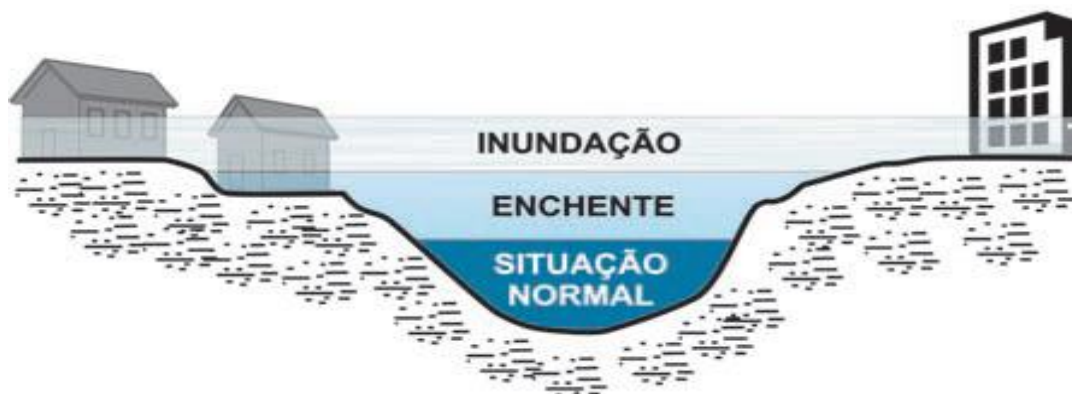
Perfil esquemático do processo de enchente e inundação (Fonte: Min. Cidades/IPT, 2007).
